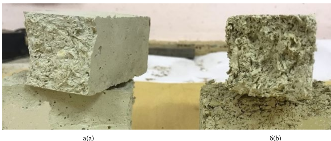
Рис. 4. Внешний вид образцов балочек после испытания на растяжение при изгибе: а – доля опилок 20%; б – доля опилок 35%
