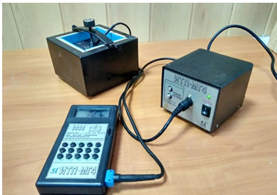
Рис. 1. Внешний вид измерителя теплопроводности Fig. 1. Appearance of the thermal conductivity meter
