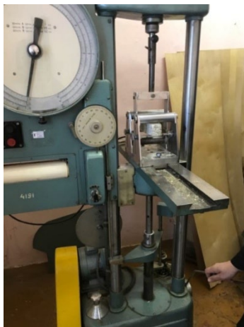
Рис. 2. Испытания образцов ДМК на установке 2166 Р-5
